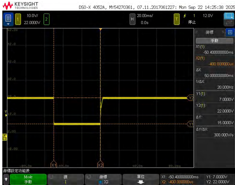
圖 62 LDC302 Test condition LLL
